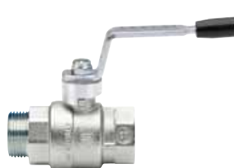
Hochtemperatur-Kugelhahn, voller Durchgang, AG/IG, Stahl-Hebelgriff mit Temperaturanzeige, MS-vernickelt.
