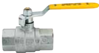
HTB Gas-Kugelhahn, schwere Ausführung, IG/IG, voller Durchgang, Zertifiziert nach DIN-EN 1775 und DIN 3537/1 hoch Temperatur beständig, Stahlhebelgriff, MS-vernickelt.
