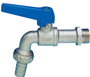
Kugelauslaufhahn PN 16 mit Schlauchverschraubung (Tülle Ø 14 mm), MS-vernickelt, Alu-Hebelgriff (blau).
