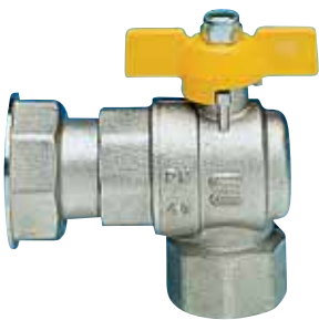
Gas-Kugelhahn, Eckausführung, IG/IG, Übw-Mutter, Alu-Flügelgriff, MS-vernickelt.
