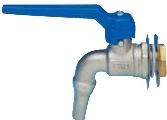
Kugelauslaufhahn PN 16 mit Dichtung und 6-Kantmutter für Tankeinbau und Auslaufdüse, MS-vernickelt, Alu-Hebelgriff (blau).
