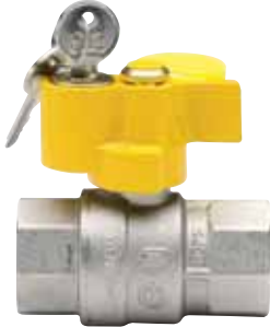
Gas-Kugelhahn, voller Durchgang, IG/IG, abschließbar mit Schloß, Alu-Flügelgriff, MS-vernickelt.
