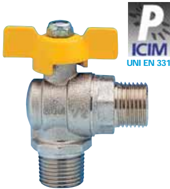
Gas-Kugelhahn, Eckausführung, red. Durchgang, AG/AG, Alu-Flügelgriff, MS-vernickelt.
