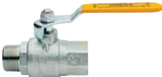
HTB Gas-Kugelhahn, schwere Ausführung, AG/IG, voller Durchgang, Zertifiziert nach DIN-EN 1775 und DIN 3537/1 hoch Temperatur beständig, Stahlhebelgriff, MS-vernickelt.
